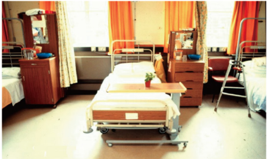
ナイチンゲール病棟では、ベッド脇に1.5m（隣の人が咳をしても届かない距離）を確保。ベッドとベッドの間の縦長の窓で自然換気
